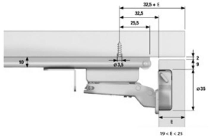
\*Utilizar con la bisagra 022020062 + la base 081000006 + tornillo F0406.
